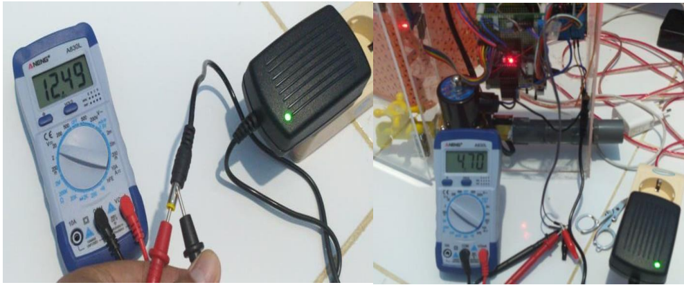
Gambar 5. 1 Hasil uji voltase adaptor dan stepdown power
