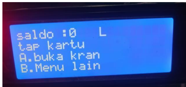
Gambar 5. 2 Hasil uji penampilan karakter pada LCD
