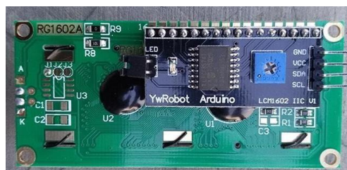
Gambar 2. 12 Pemasangan modul I2c dan LCD
