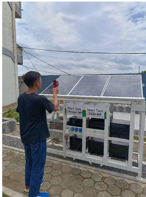
Gambar 4.6 Pengukuran Suhu pada Panel Monokristalin
