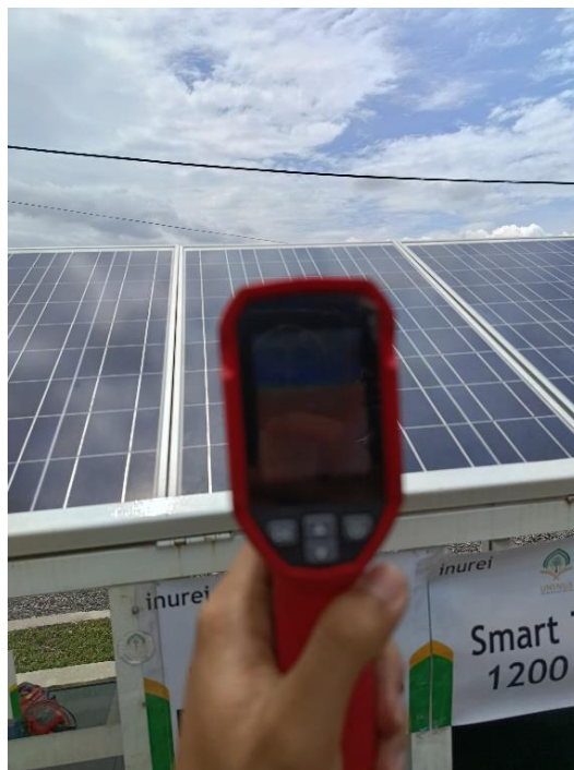
Gambar L.8 Gambar Pengukuran Suhu Permukaan Panel Surya
