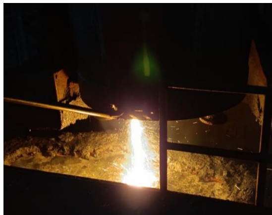
Gambar 3 Proses memasukan cairan ke tundish (Sumber: PT. Sentosa Harmony Steel)
